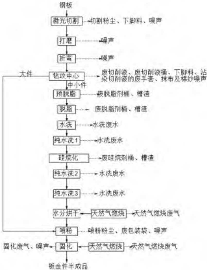
图 3-2 智能物流设备钣金件半成品生产工艺流程及产污环节
