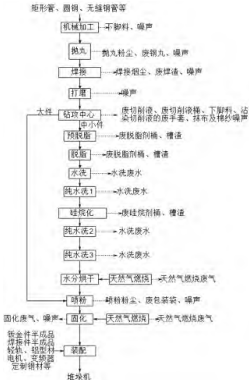
图 3-4 堆垛机生产工艺流程及产污环节
