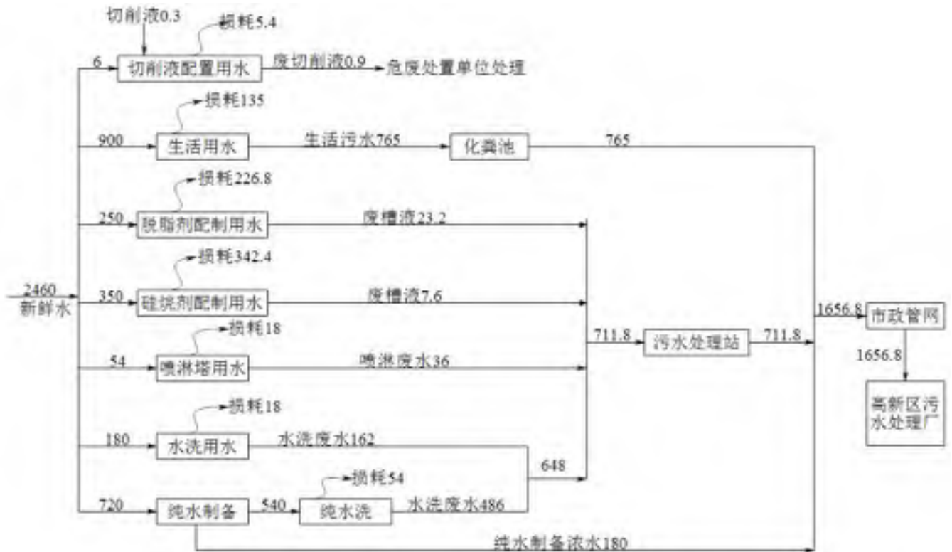
图 3-1 本期项目水平衡图 (t/a)
