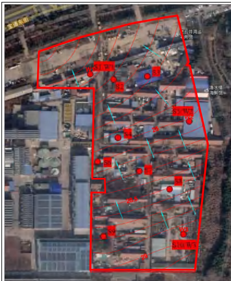
图 3.6-1 地块地下水水位等值线及流向图
