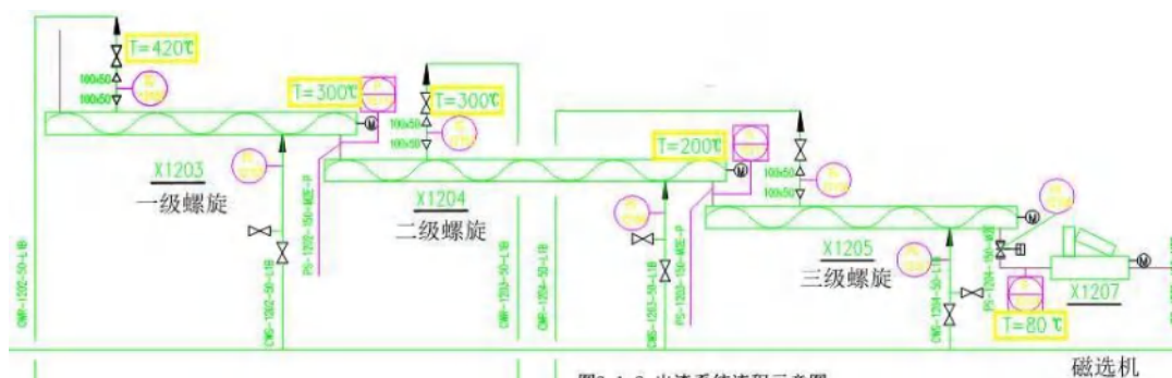
图 3-3 裂解釜碳渣出渣系统示意图
